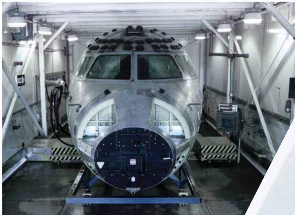
Les essais que nos clients réalisent dans nos chambres environnementales, à des températures situées entre - 55 °C et + 85 °C, servent à déterminer les conditions optimales ou critiques de fonctionnement d'équipements, de systèmes de chauffage, de dégivrage et plus encore, afin d'assurer la sécurité et le confort des conducteurs et de leurs passagers.
